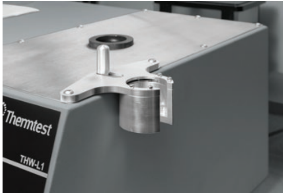
无安装样品的垂直元件座。
