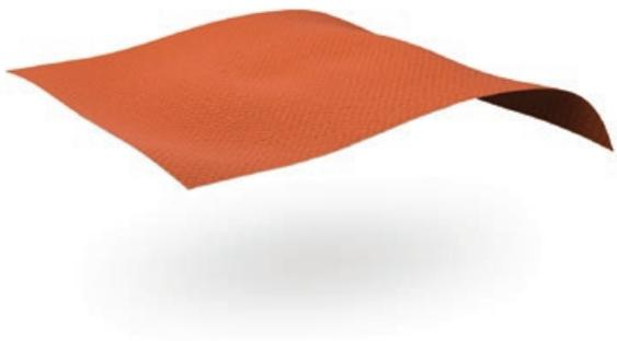
使用TPS-EFF，可以测试大小不限的样品；样品的直径应至少为30 mm，以实现与TPS-EFF传感器的接触。该仪器可以测量各种织物、面料和固体。应注意确保样品有足够的厚度，以便可以使用发散技术来证实这一点。
