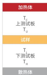
一旦样品两端的温度达到了稳态, 就可以应用傅里叶传导方程了。可以很容易地证明, 对于任何固体样品, 从测量的温度可以得到  $R_s$  ( $m^2 K/W$ ), 等于样品的厚度  $d(m)$  与其热导率  $\lambda$  ( $W/mK$ ) 的比值:
